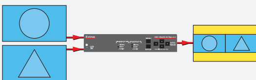
Входы с одинаковыми разрешениями, скалируемый выход до 4K/60
