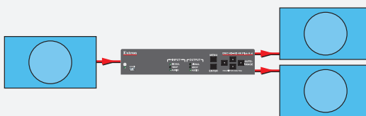
Одноканальный вход для разрешений до 4K/60, дублирующие скалируемые выходы до 4K/60
